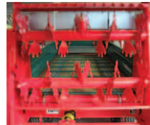
Geteilter Kettenantrieb für Streuwerke mit liegenden Walzen.
