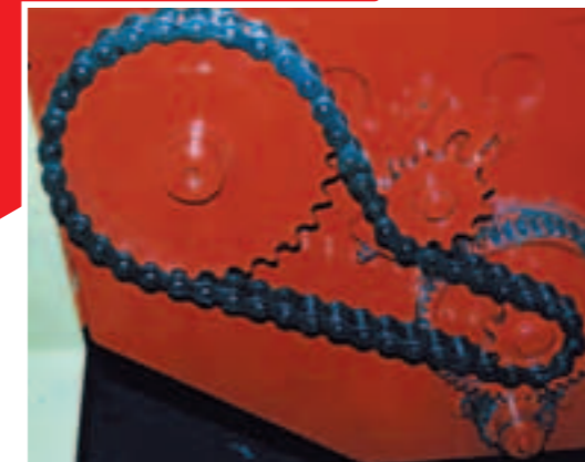
Hydraulischer Kratzbodenantrieb mit Kettenübersetzung (bei Type B3035 bis T3040 serienmäßig).
