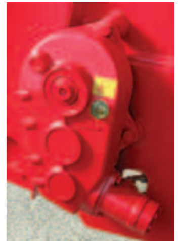
Hydraulischer Kratzbodenantrieb mit Ölbadgetriebe (bei Type T3050 bis T3080 serienmäßig).
